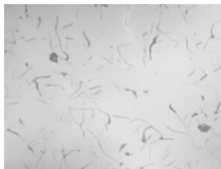
(a) 腐蚀前的石墨照片100×
