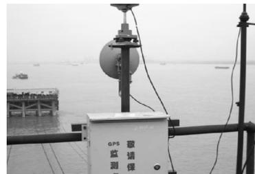
图 4 GPS 监测仪器安装
