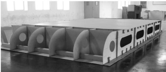
图 3 双层底分段模拟建造结构图
