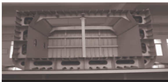
图 1 12500 吨多用途散货船中部总段模型
