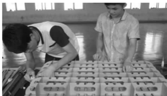
图 3 双层底分段装配示意图
