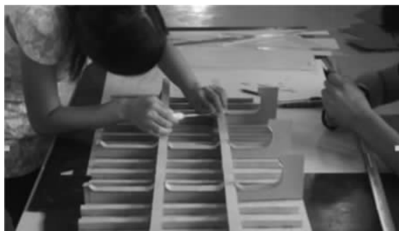
图6 横舱壁分段装配示意图
