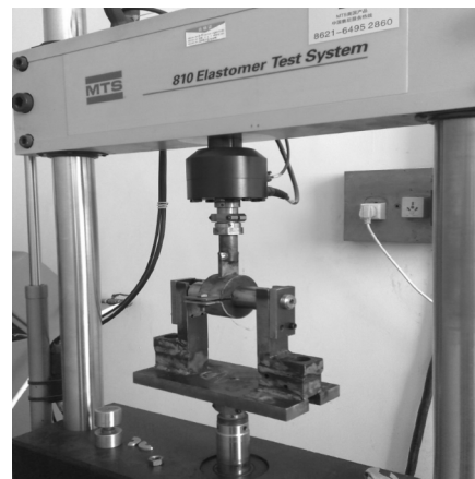
图 4 T型管道支架安装测试图
