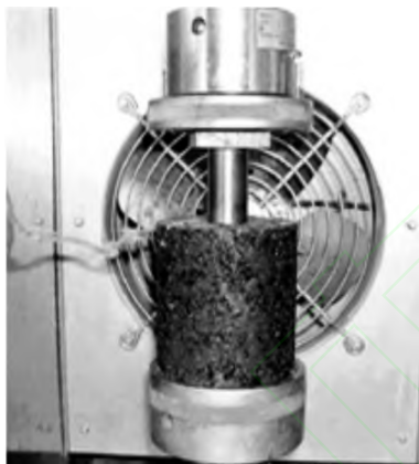
图 1 单轴贯入试验模型
